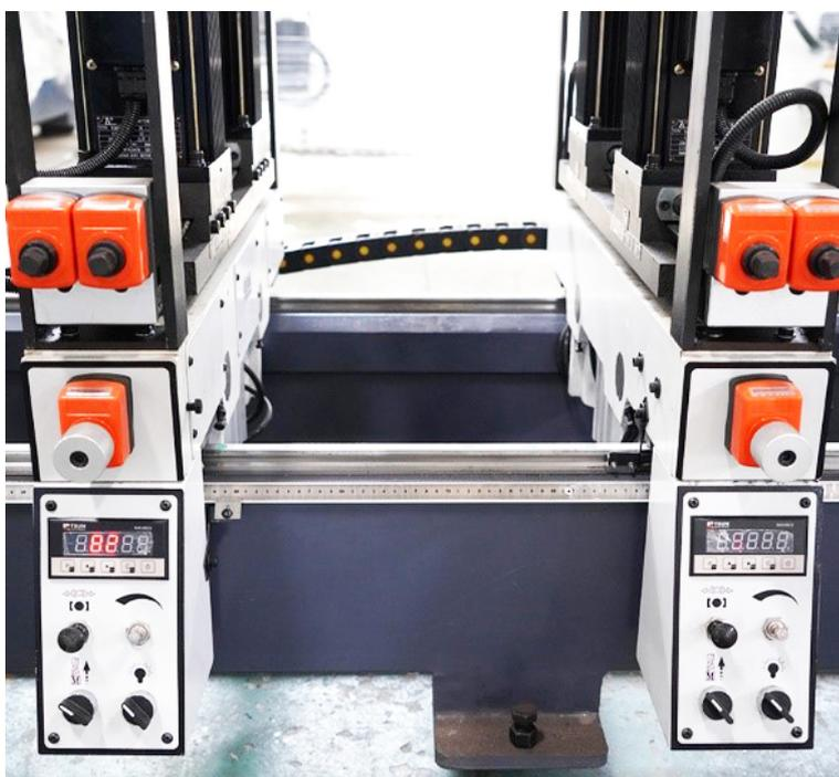
Перемещение нижних вертикальных траверс происходит на призматических направляющих с линейными подшипниками, что обеспечивает точность и плавность хода. Фиксация траверсы на заданном месте надежно осуществляется с помощью пневматического тормоза. Заданный размер индицируется на цифровом табло.
