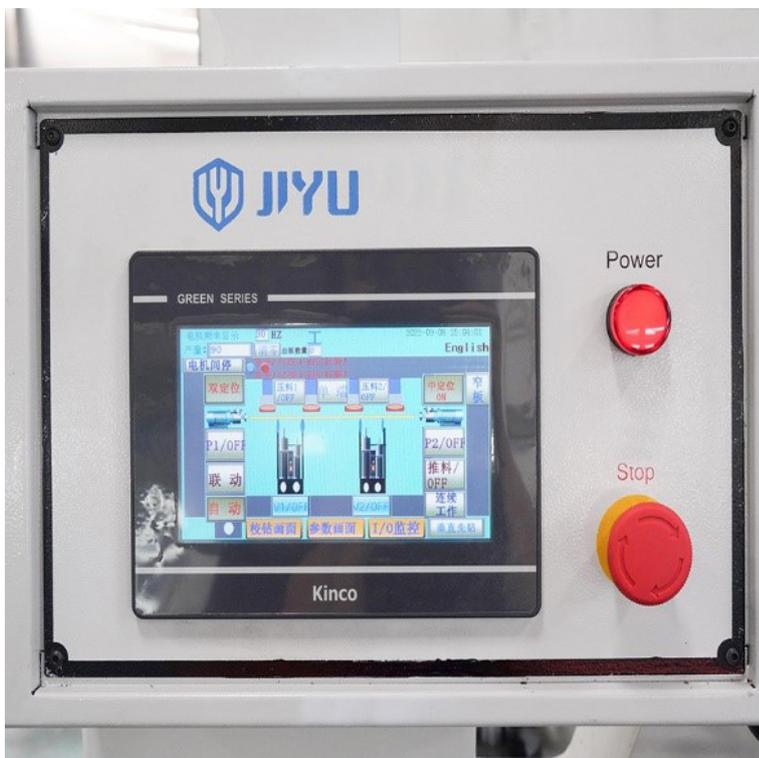
Управление сверлильными группами производится с промышленного контроллера с ЖК дисплеем.
