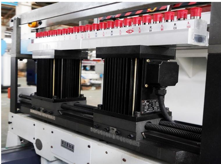
Каждая вертикальная траверса разделена на 2 секции с двумя моторами. При необходимости каждая из сверлильных секций может быть развернута в положение вдоль или поперек детали.
